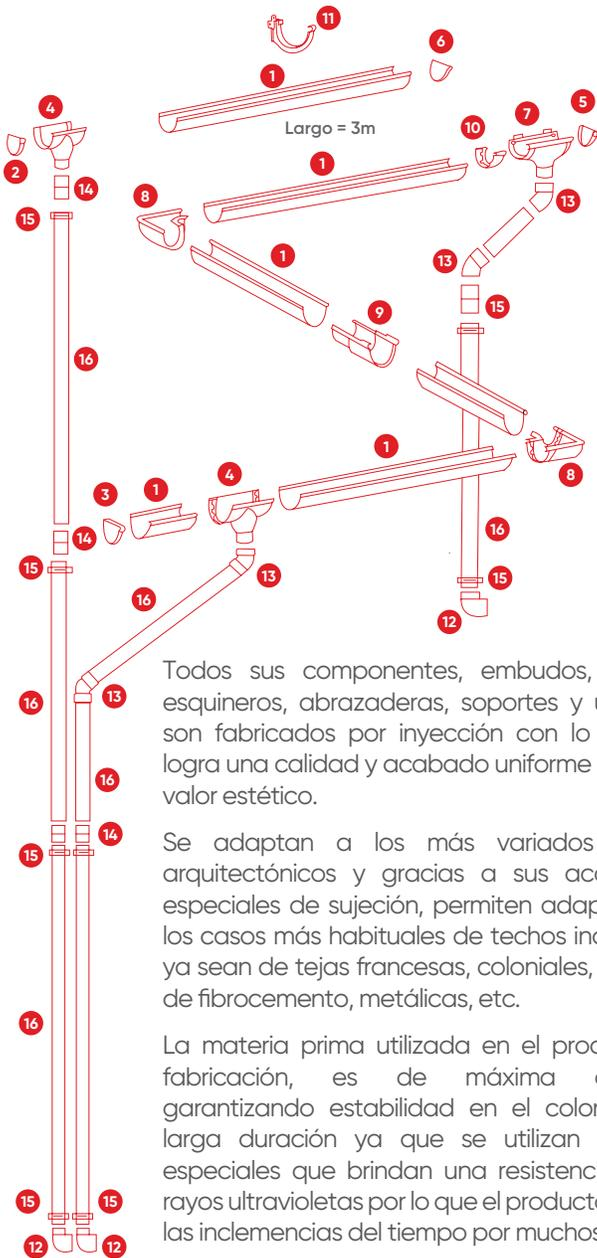
Todos sus componentes, embudos, codos, esquineros, abrazaderas, soportes y uniones, son fabricados por inyección con lo que se logra una calidad y acabado uniforme de gran valor estético.
